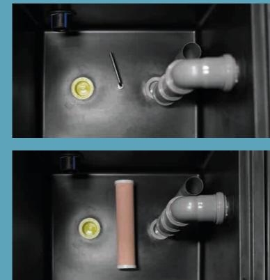
Для этого откручиваются винты на дне резервуара, а керамические фильтры, входящие в комплект, закручиваются вручную. Дождевая и/или поверхностная вода (из рек и озер) поступает в камеру 1, оттуда она поступает в фильтровальные камеры 2 + 3. Установленные на дне керамические фильтры подают фильтрованную воду в **БАК ДЛЯ ПИТЬЕВОЙ ВОДЫ CAIRDROP**.
